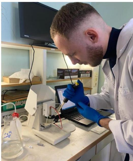
Работа с аппаратом инверсионной вольтамперметрии
