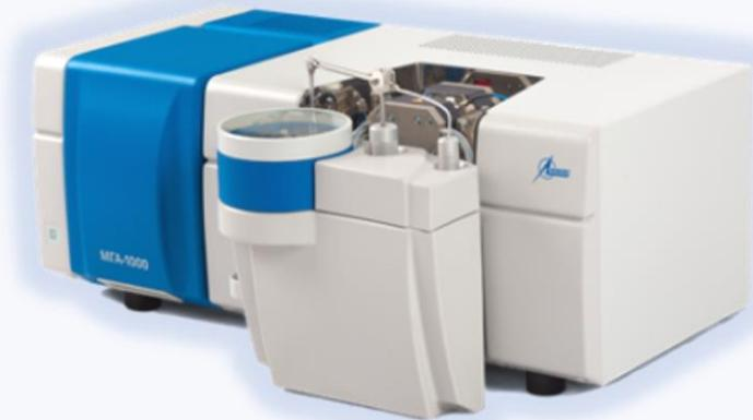
Возможность использования безэлектродных разрядных ламп позволяет существенно снизить пределы обнаружения для таких элементов как As, Bi, Cd, Hg, P, Pb, Sb, Se, Te, Tl и отказаться от использования гидридной техники для решения большинства рутинных задач.
