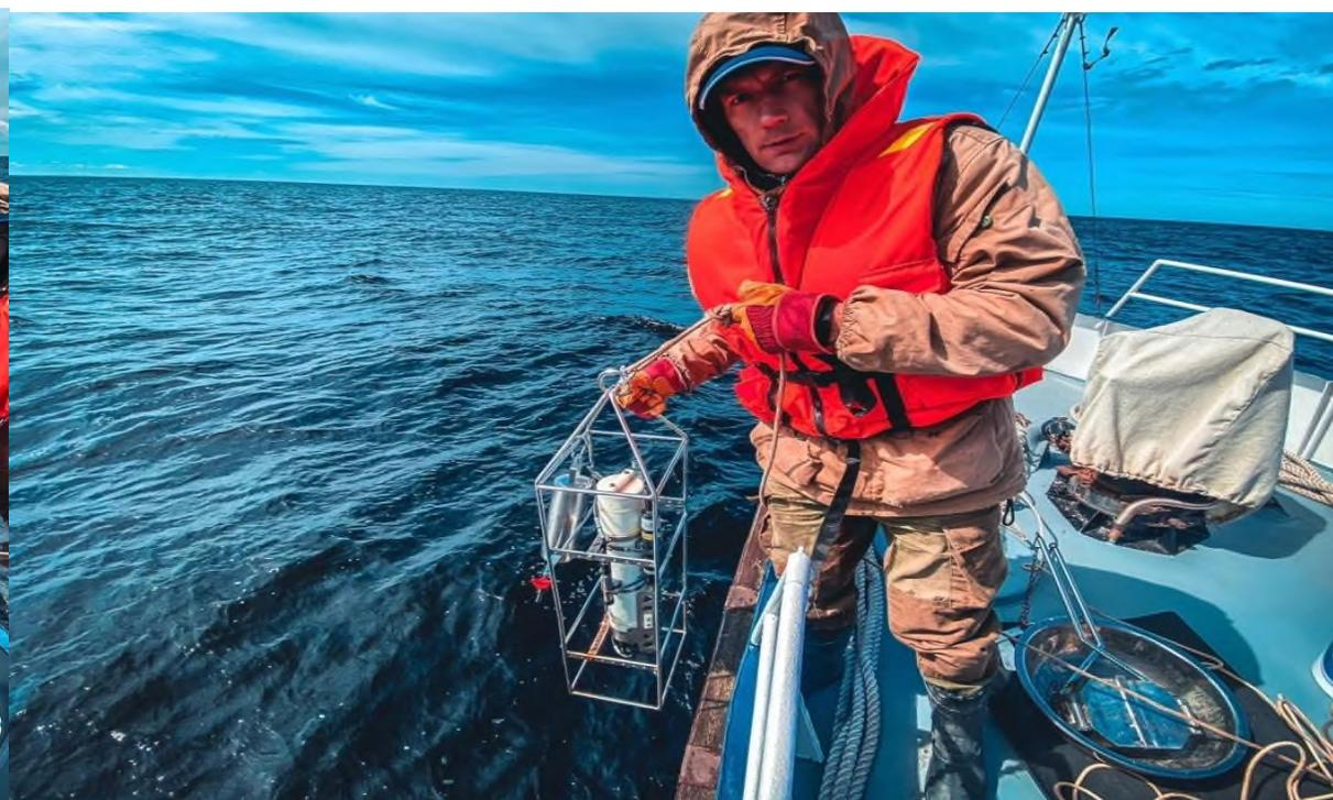
На каждой станции выполняется зондирование водной толщи с помощью океанографического зонда SBE-19 SEA BIRD и Многопараметрического зонд Aqua troll 500
